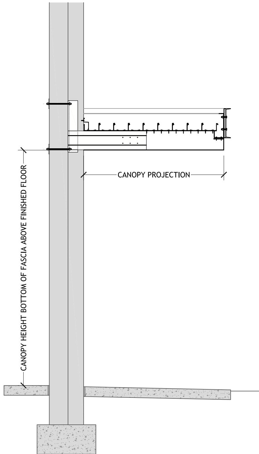
**CAVITY WALL BOOT SUPPORT 10 INCH FASCIA GUTTER FLUSH DECK
