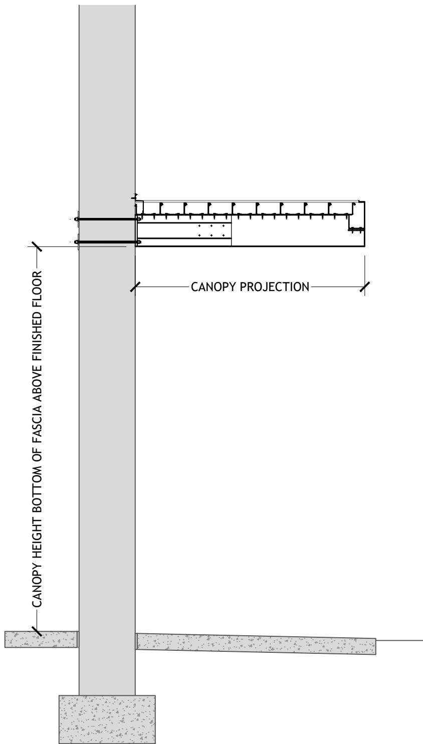
**FACE MOUNT BOOT SUPPORT 7 INCH FASCIA GUTTER FLUSH DECK**
