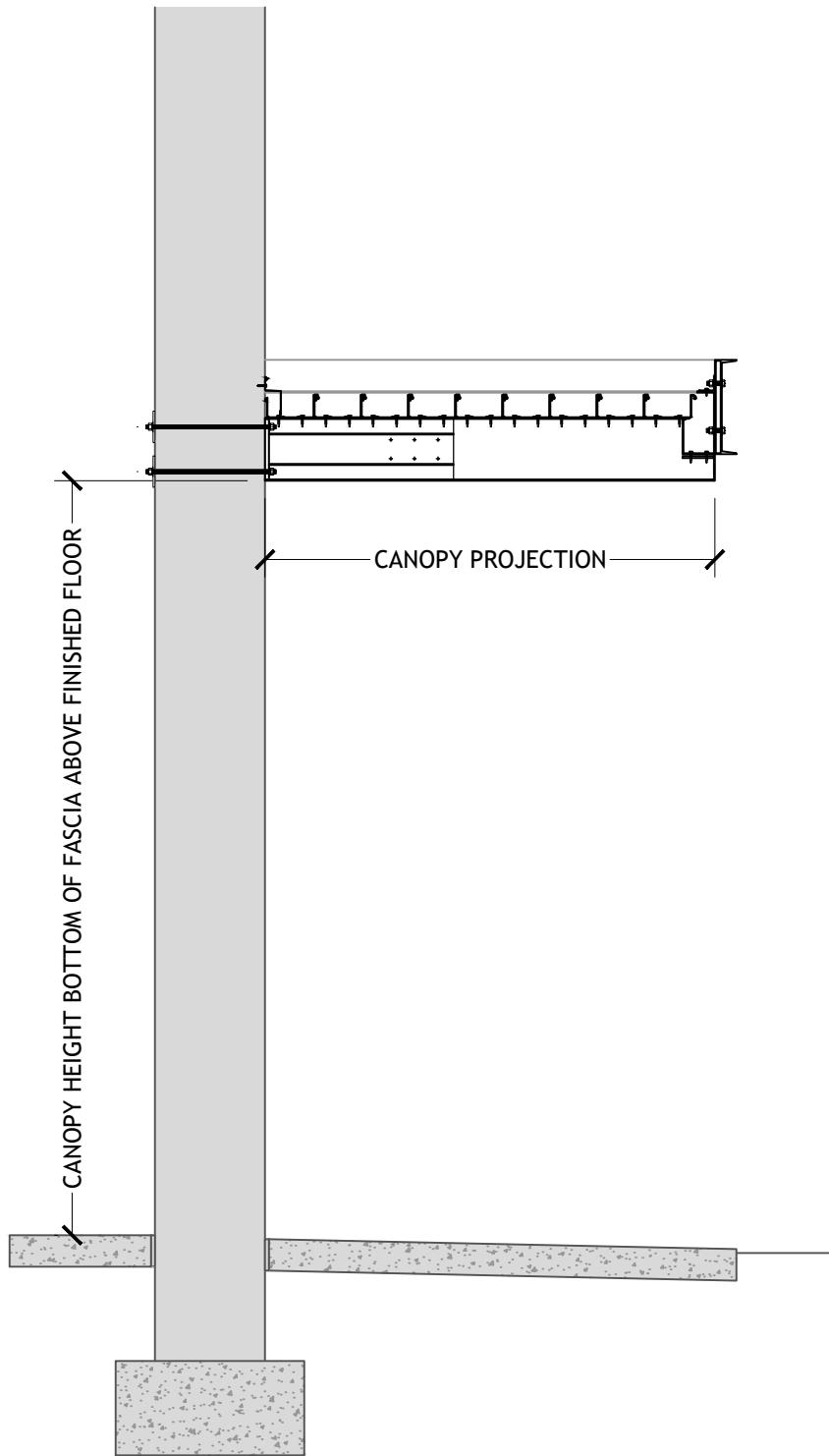
**FACE MOUNT BOOT SUPPORT 8 INCH FASCIA GUTTER FLUSH DECK
