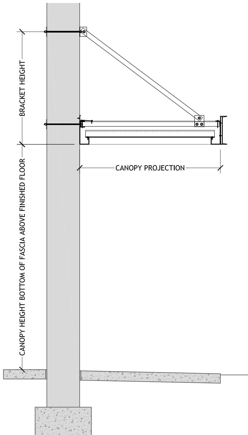
STANDARD OVERHEAD SUPPORT 10 INCH FASCIA GUTTER FLUSH DECK
